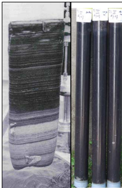
Figuur 1. Voorbeeld van gelaagd sediment in een diep Alpenmeer links (Lotter, 1998) en homogeen organisch materiaal (20-220 cm diep) uit de Loenderveense Plas rechts (dit onderzoek)
